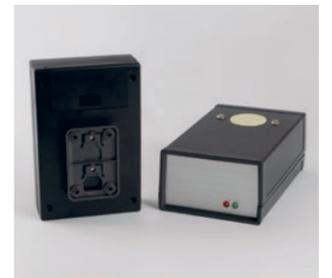
使用される電源ユニットの電圧出力の異常を監視・検知する電源監視モジュールを試作開発しました。
